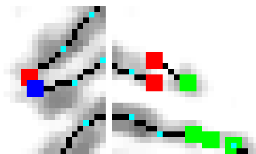
Rysunek 3.9: Błędnie wykryte minucje na obrzeżu odcisku palca
